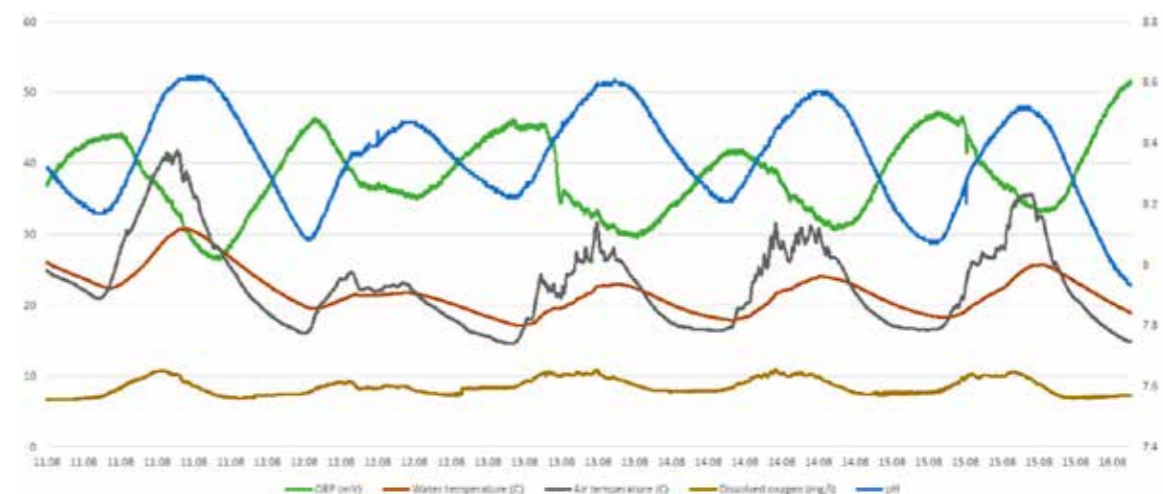
Kuva 2. Kuuden päivän mittausjakso, jossa näkyy selvästi vuorokausikierron vaihtelu. Mittauskohteina redox-potentiaali, lämpötilat, pH, liuenneet happi.
