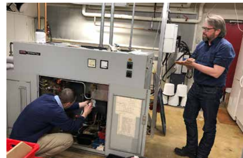
Kuvassa puhdistetaan tislaukolonnin höyrykehittäjä yhdessä Tomas Björkqvistin kanssa.
