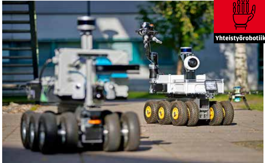
Maarobotteja (alias Mörrri) voidaan käyttää sisällä ja ulkona. Modulaarinen rakenne mahdollistaa erilaisten anturiratkaisujen liittämisen ja tehollisten käyttämisen joustavasti. Kehitystyötä on tehty yhteistyössä Probot-yritykse kanssa.
