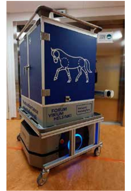
Omron LD-250 kuljettaa ruoan Helsingissä vanhusten palvelutalossa.
