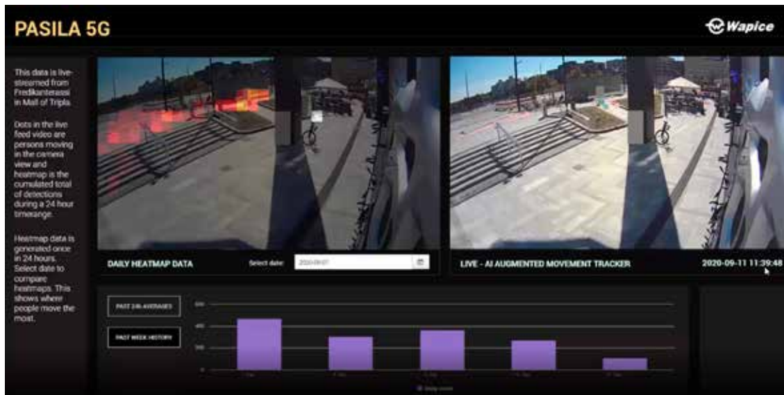
Kauppakeskuksen tekoälyä hyödyntävän kamerajärjestelmän laskenta tehdään paikan päällä edge-laskentana. Vain laskennan tulokset välitetään pilvipalveluun ja sieltä edelleen sovelluksen käyttäjille.
