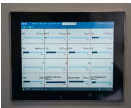
SICK MCS200HW-analysointorin kosketusnäyttö kertoo yhdellä vilkaisulla mitattavien komponenttien arvot ja laitteen statuksen.
