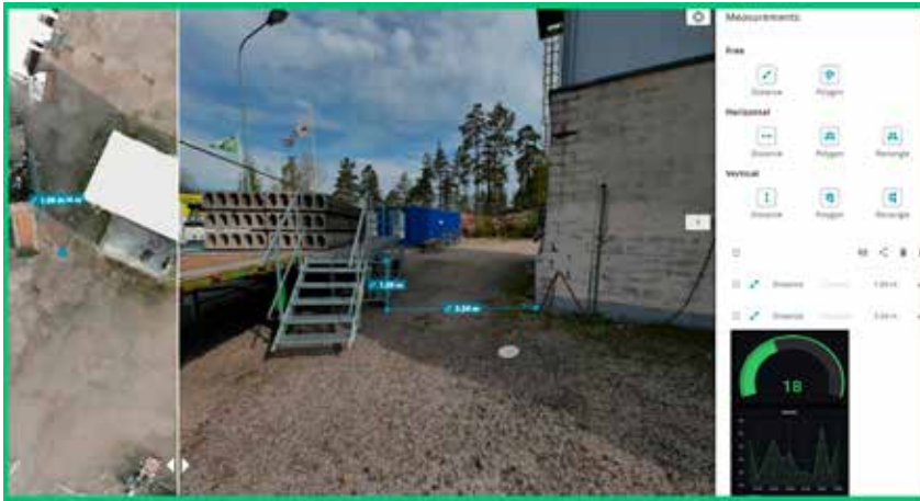
eSiteview mahdollistaa etävierailut työmaalla, rakenteiden mittaamisen, dokumenttien liittämisen paikkatietoon, 3D-tiedon tuottamisen ja integroimisen erilaisiin IoT-järjestelmiin.
