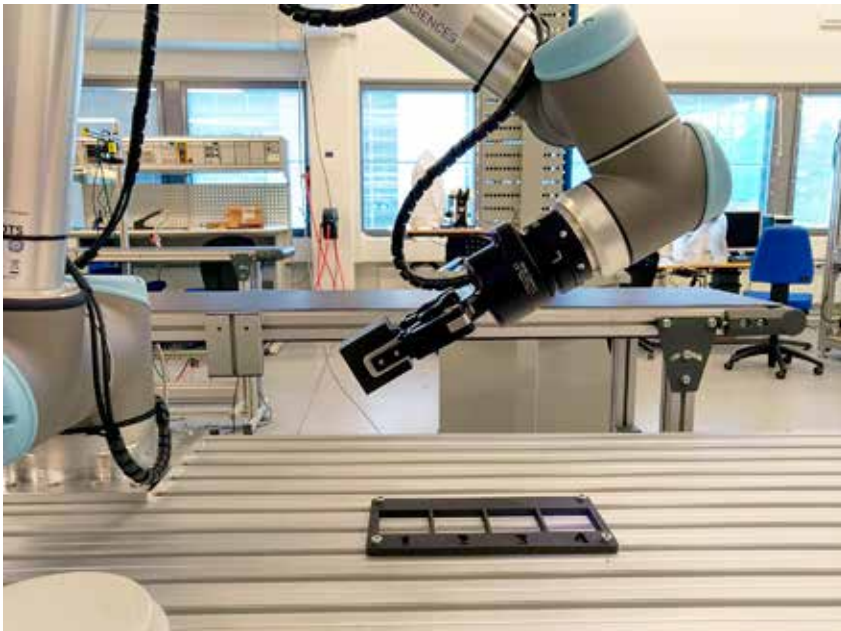
Yhteistyörobotti poimimassa kappaletta punnitusovelluksessa.
