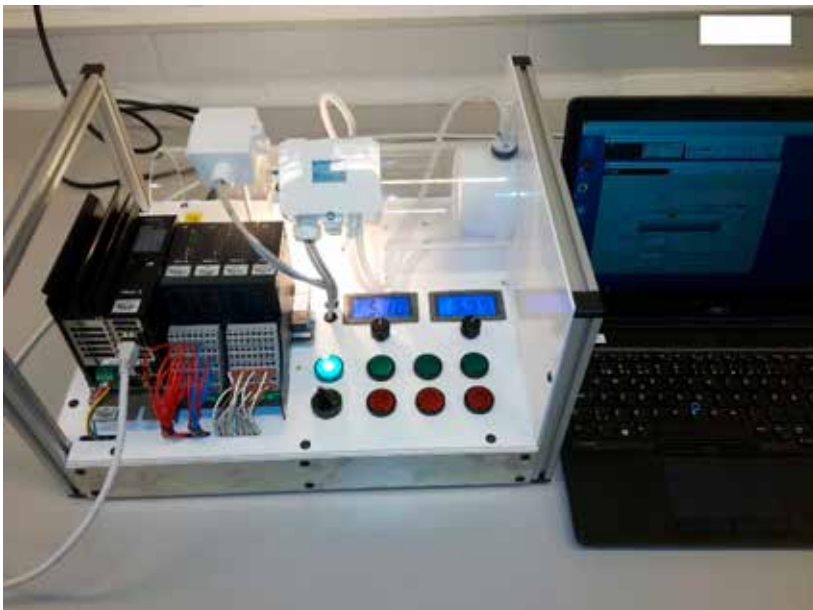
Kannettava säätötekniikan oppimislaitteisto.
