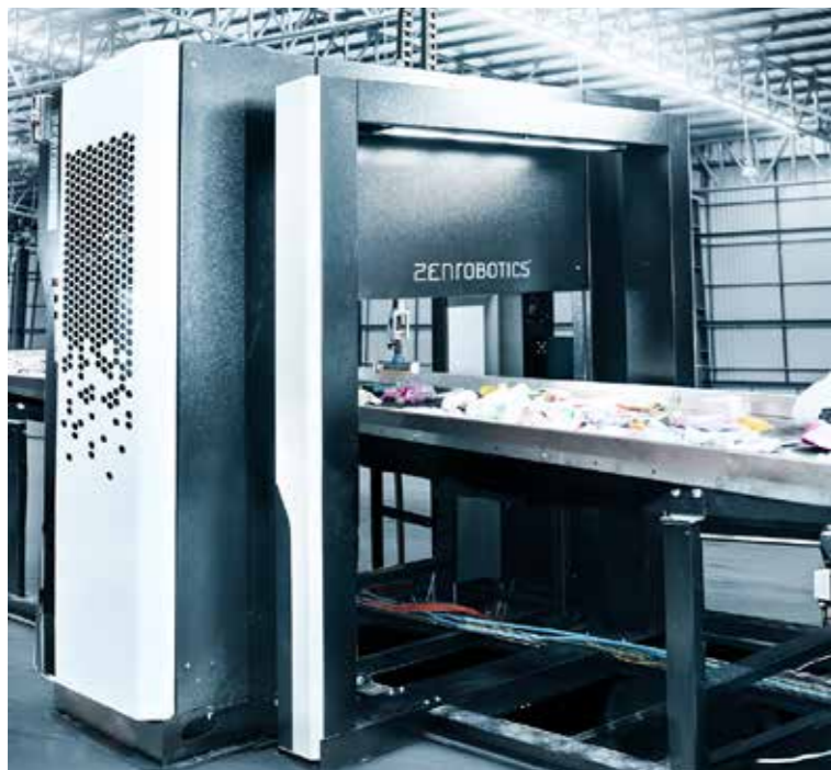
Robottimalli, joka poimii mm. pakkausjätettä.
