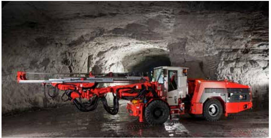
Kuva 1. Tyypillinen maanalainen tunnelinporauslaite varustettuna porauspuomilla.
