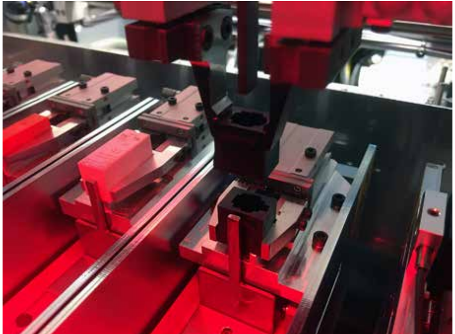
Syöttölaitteelta poimittu komponentti robotin tarttujassa matkalla tarkastukseen ja ladontaan.
