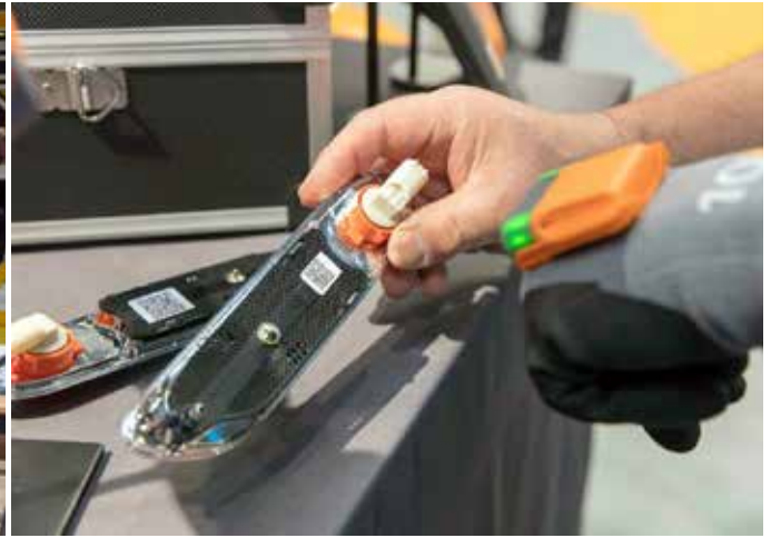
Proglove hansikasskannerilla voi välttää kokoonpanovirheet.
