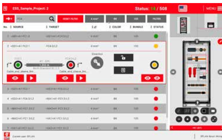
EPLAN Smart Wiring ohjelma esimerkiksi tabletilta käytettynä tuo ajantasaiset digitaaliset tiedot ohjauskeskusten johdotukseen.
