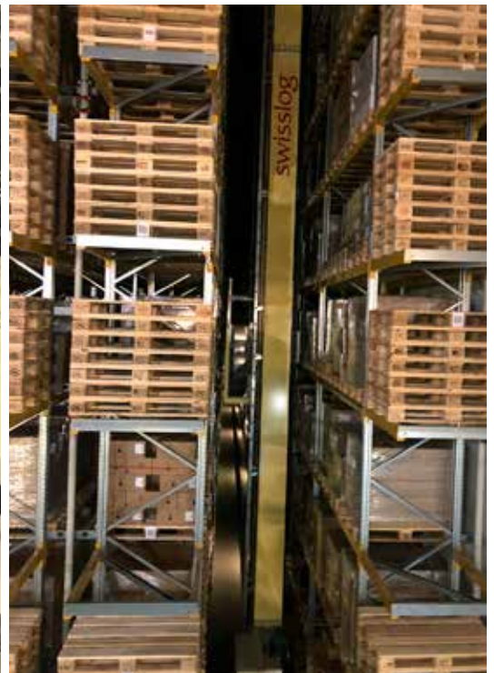
Tamron Swisslog-korkeavarasto toimii automaatioidusti.
