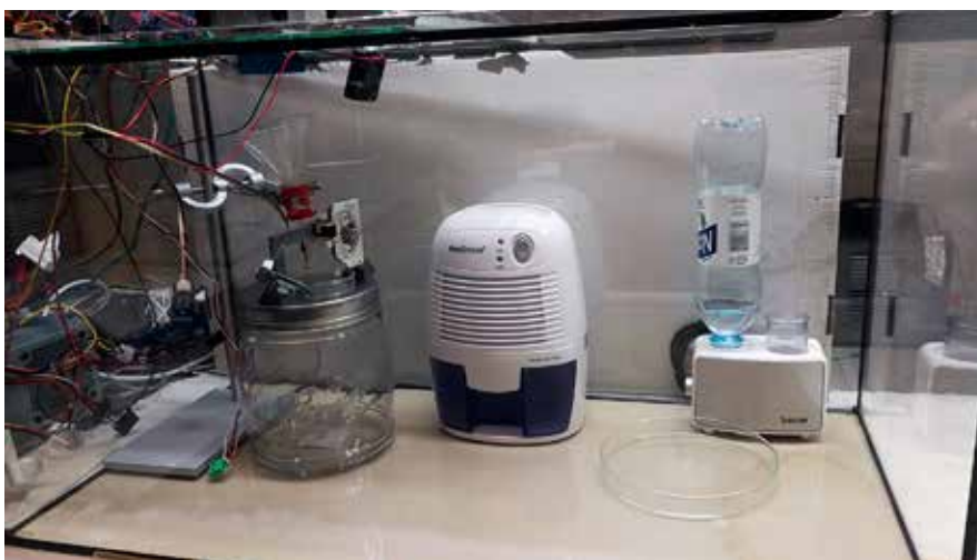
Kuva 3. Tutkittava aine sijoitettiin kammion pohjalle lasivatiin. Kammioilmaa kostutettiin ultraäänihöyrystimellä. Kammion ilman kosteus tiivistettiin Peltier-kuivaimella vedeksi. Kammiossa mitattiin jatkuvatoimisesti lämpötilaa, kosteutta, TVOC-pitoisuutta ja tiivisteveden pintajännitystä.
