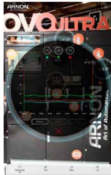
AR-sovelluksella laitteen mittaustiedon näkyy kamerasovelluksen kuvassa osoitettaessa päätelaitetta
