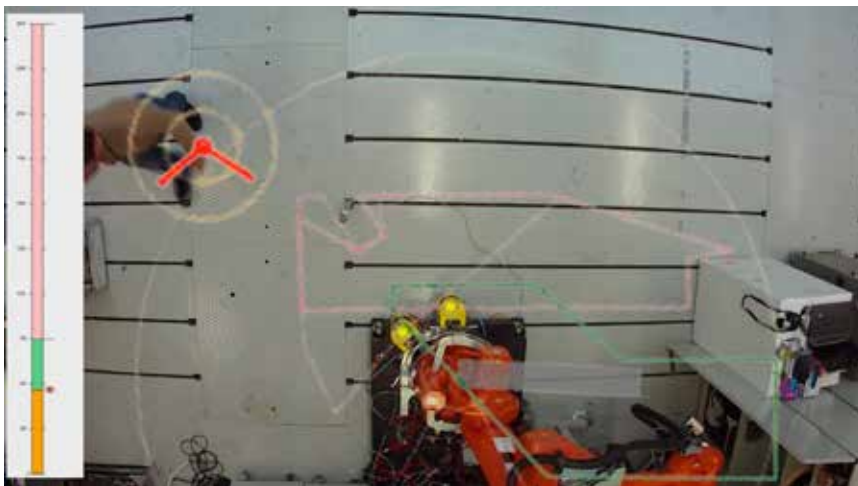
Informaationäyttö, joka esittää havaitun ihmisen, robotin sallitun alueen ja pysäytysalueen.
