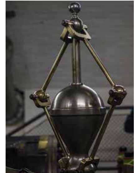
Osa höyrykoneen nopeudensäätimen mekanismista.
