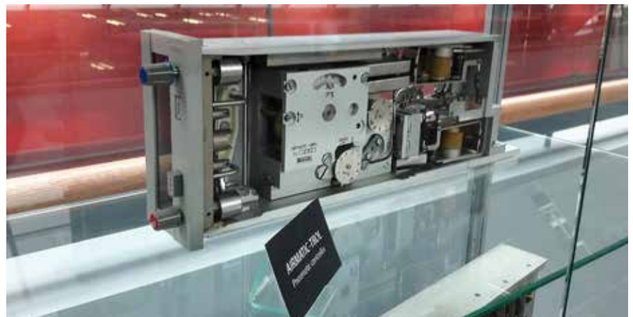
Honeywellin valmistama, kentälle asennettava pneumaattinen PID-säätäjä.
