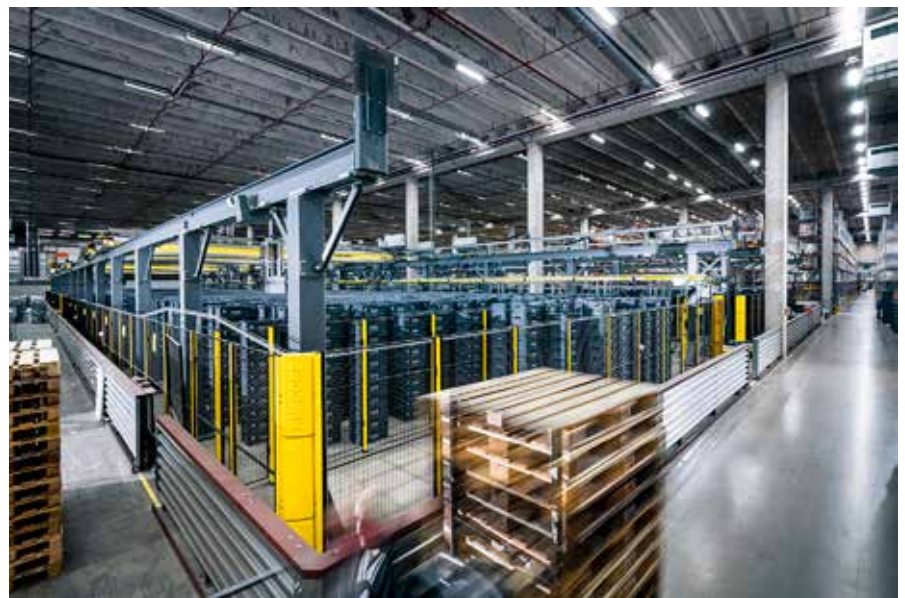
3D Shuttle on Cimcorpin kehittämä automatisoitu goods-to-person-keräilyratkaisu, joka sopii vähittäis-, tukku- ja verkkokaupan logistiikan tarpeisiin.
