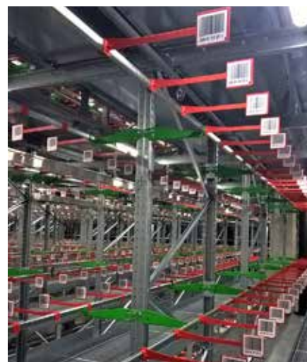
Stockmannin varastossa jokaisessa hyllypaikassa on tunnistin. Sen avulla automatisoidut varastosukkulat löytävät oikean tavarantoimituksen, joka lähetetään kuljettimilla keräilypisteeseen pakattavaksi.
