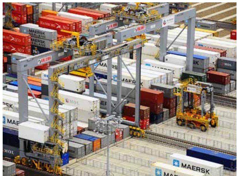
Automaattitrukit vievät kontit laiturilta varastoalueella. Varastoalueen ASC-nosturit pinoavat kontteja odottamaan laivoja. Toisessa päässä kontit lastataan odottaviin rekkoihin.
