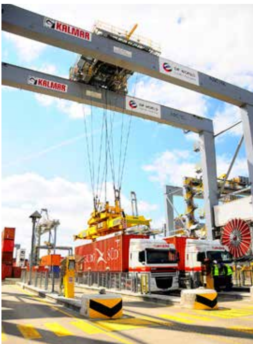
Automaattitrukit vievät kontit laiturilta varastoalueella. Varastoalueen ASC-nosturit pinoavat kontteja odottamaan laivoja. Toisessa päässä kontit lastataan odottaviin rekkoihin.
