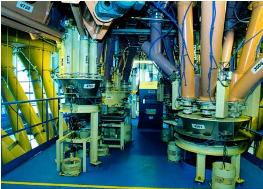
Kuiva-aineiden sekoittaminen oikeaksi lopputuotteeksi vaatii mittauslaitteilta kykyä tuottaa jatkuvasti oikeita mittaustuloksia. Seossuhteet voivat olla jopa 1/100 tai allekin. Kuvassa rakennusteollisuudelle tuottavan tehtaan vaa'at, joilla on myös jokaisella omat automaattisesti toimivat tarkastuspunnukset. (Kuva Lahti Precision Oy)
