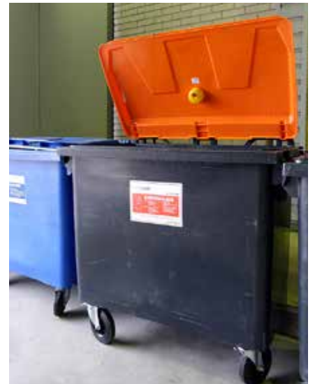
Enevon sensori kiinnitetään tyyppillisesti roskasäiliön kanteen.
