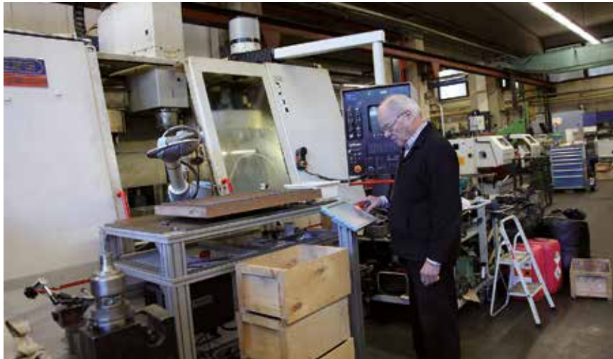
Konetehdas K&K:lla on kaksi UR5-robotia. Robotit ovat tarjoiluvaunua muistuttavien alustojen päällä, joten niitä on helppo liikuttaa työpisteestä toiseen. Kari Karaslahti arvostaa robottien helppokäyttöisyyttä ja turvallisuutta.
