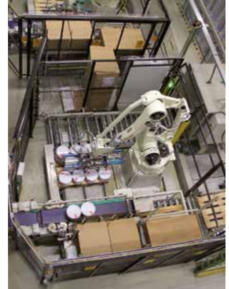
Tikkurilan maalien tuotanto on pitkälle automatisoitu. Robotteja käytetään muun muassa maalipurkkien lavaamisessa.
