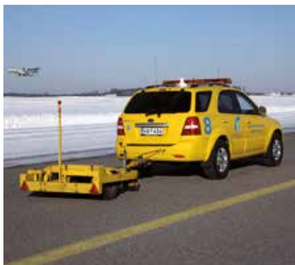
Kiitoteiden kuntoa valvotaan jatkuvasti sekä kiinteiden antureiden että liikkuvien mittausaseman välittämän datan avulla.
