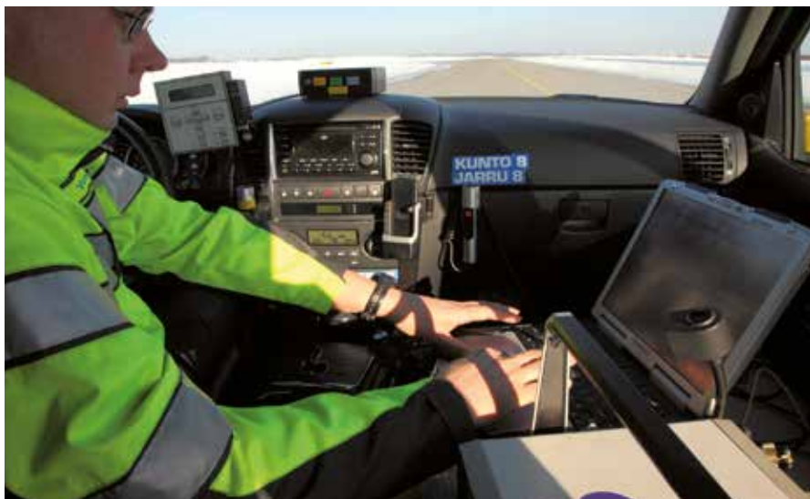
Kiitoteiden kuntoa valvotaan jatkuvasti sekä kiinteiden antureiden että liikkuvien mittausaseman välittämän datan avulla.
