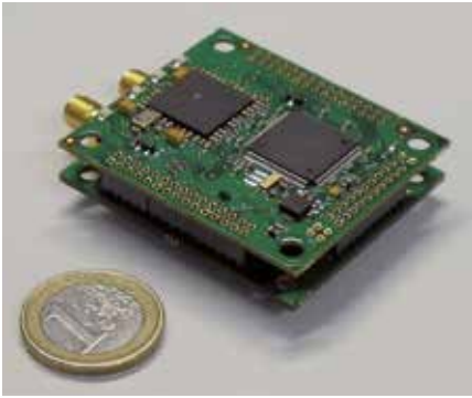
VTT:n EFFIMA-ohjelmassa käyttämä VTT Node langaton mittaussmoduli.
