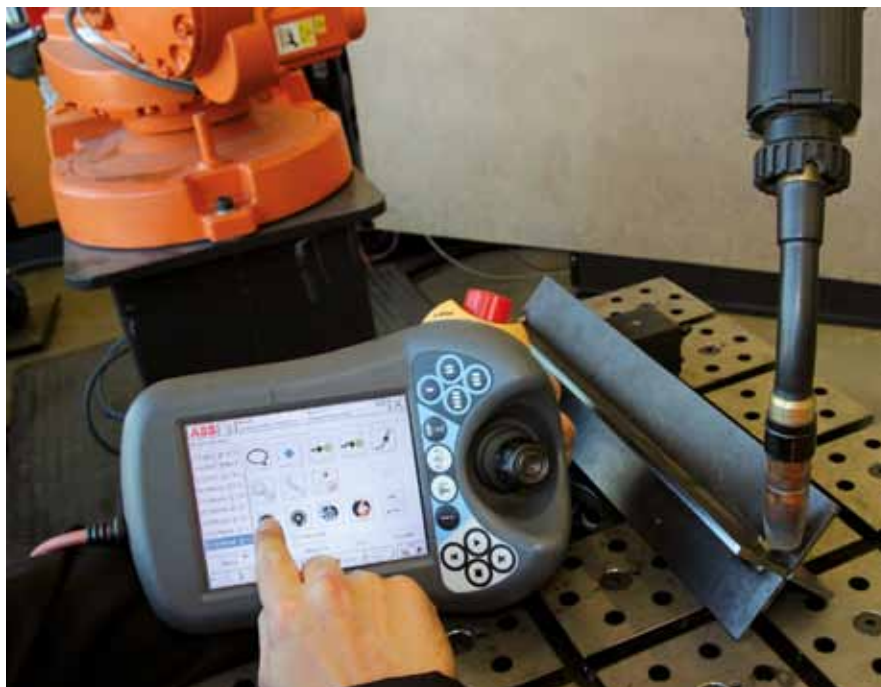
Kuva 4. Käyttöliittymä sekä valmista hitsausohjelmaa.
