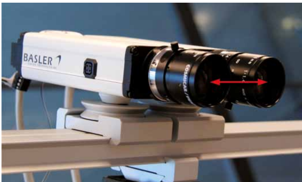
Stereokameraparin linssien polttoväli sekä kameroiden välinen etäisyys säädetään operoitavan kohteen mukaan.
