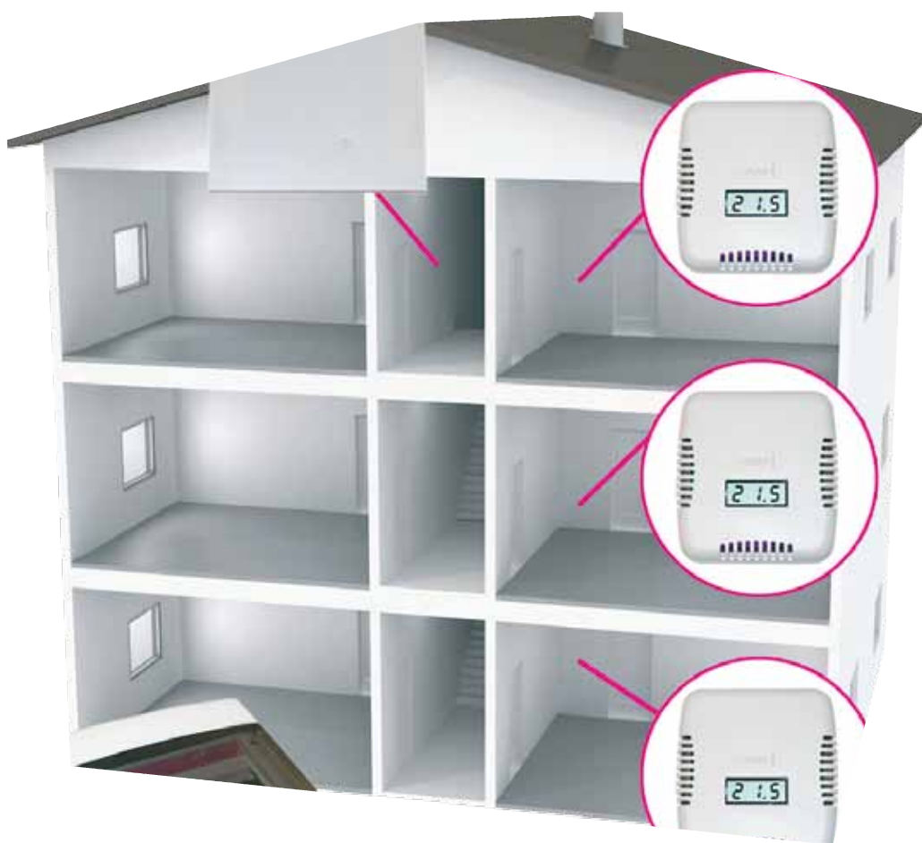
Havainnekuva SiMAP-säätöjärjestelmästä, jossa jokaiseen huoneistoon asennetaan oma lämpötilan mittausanturi.
