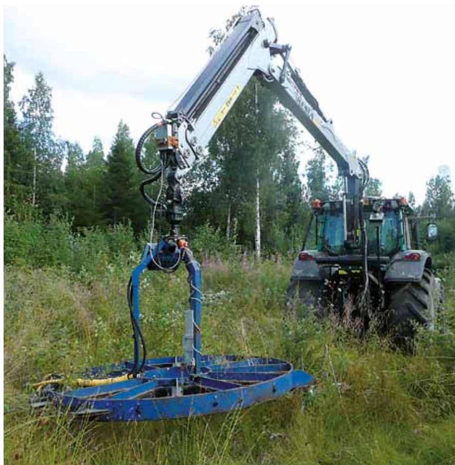
Neosilvix-projektissa käytetty laitteisto koostuu traktorista, automaattiohjausta varten instrumentoidusta metsäkonepuomista ja reikäperkaimesta.
