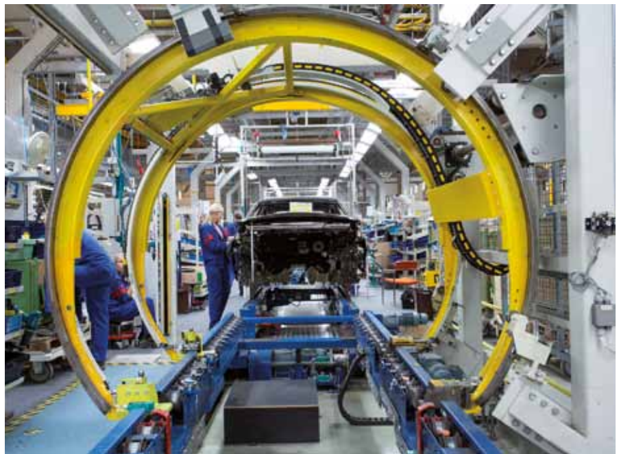
Jokainen ajoneuvokori tunnistetaan RFID-tunnisteella, jonka perusteella tuotantosolu lataa tarvittavat reseptitiedot.
