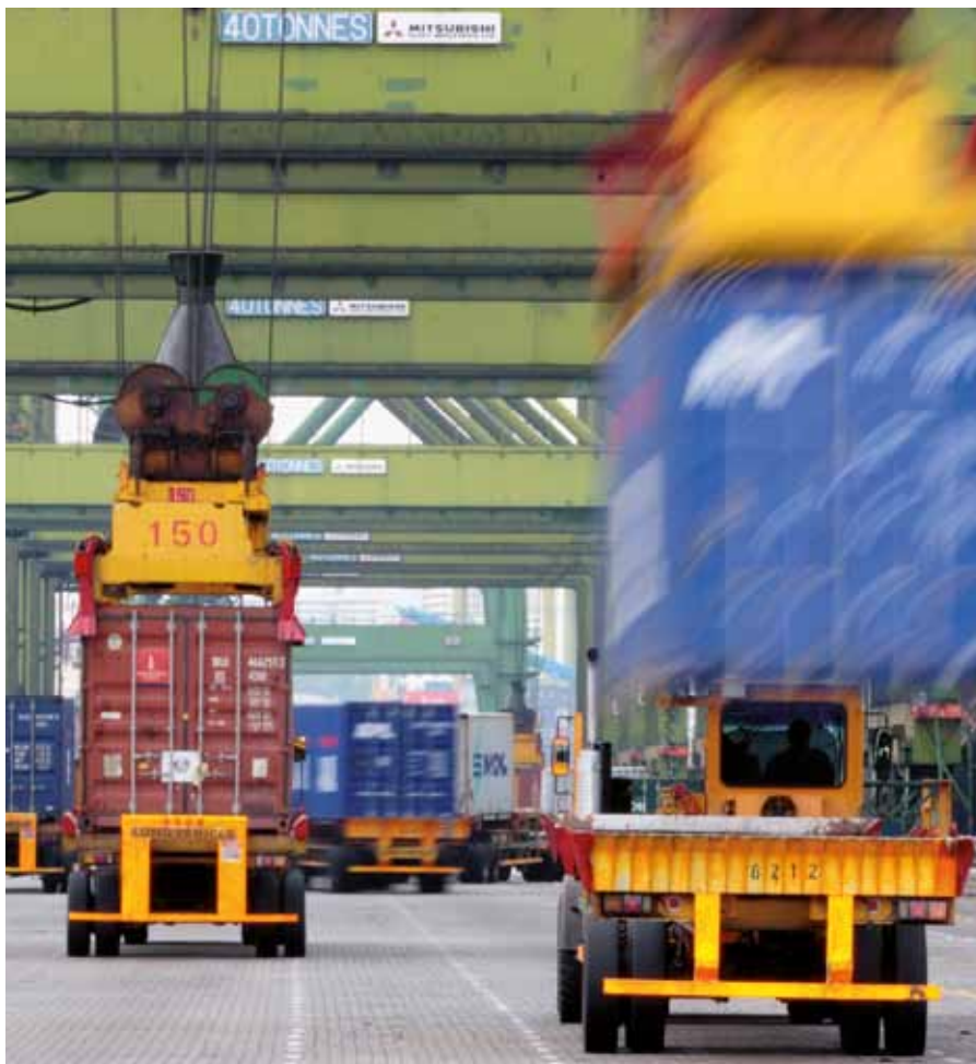
Singaporen satamassa massiiviset rautanosturit luovat katve-alueita, joissa radiosignaalit eivät kulje.
