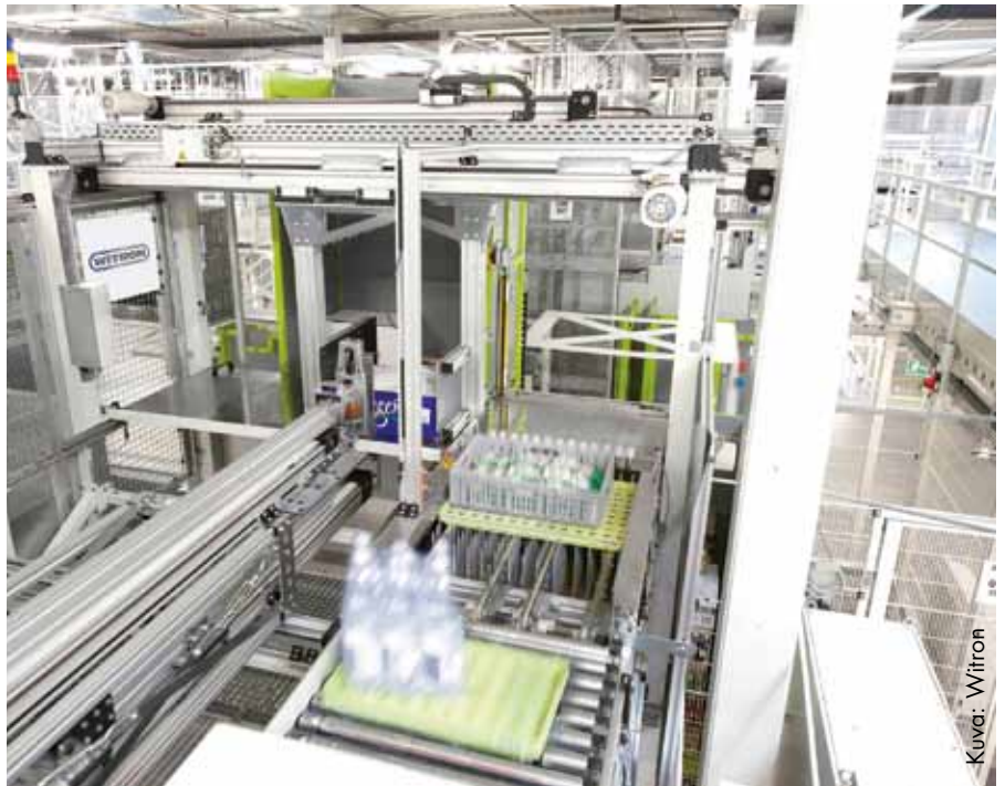
Joustavasti eri pakkauskokoihin sopeutuvat lavaajat ovat tärkeä osa tuotekollien automaattista keräysprosessia.
