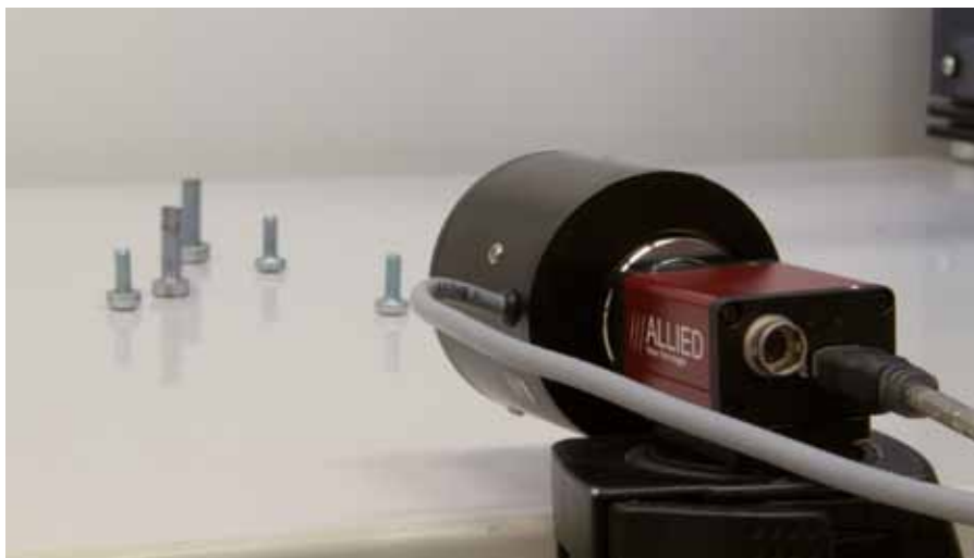
Depth from focus -kuvaus toteutettuna moottoroidulla tarkennuksella toimivaa optiikka käyttäen.
