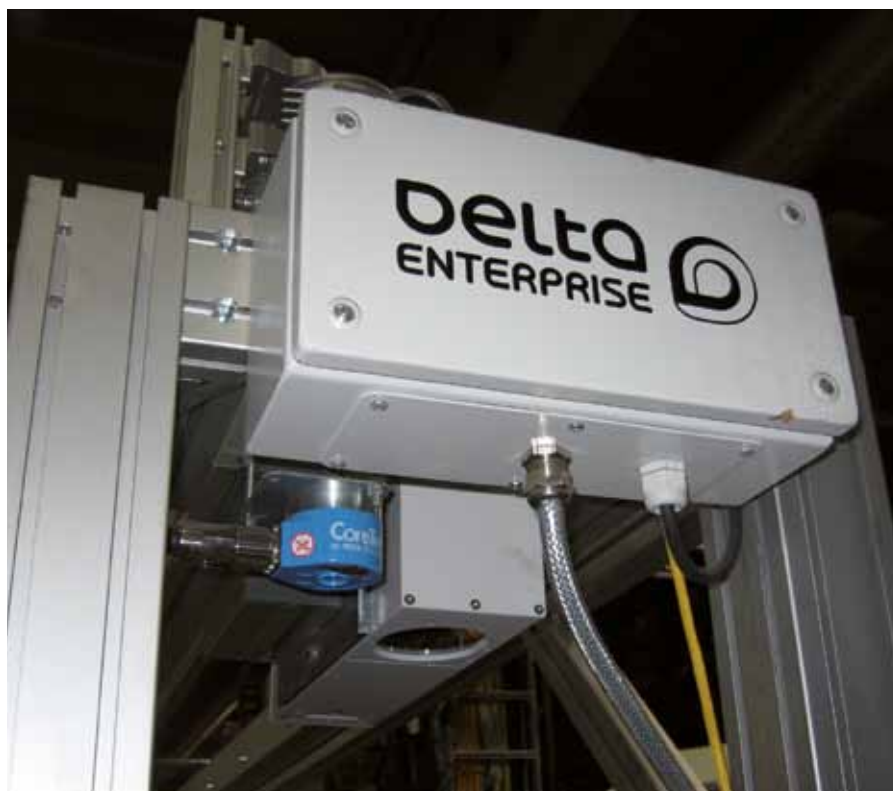
Mittalaitteen runko, Ruler-kamera ja mittauksia ohjaava enkooderi.
