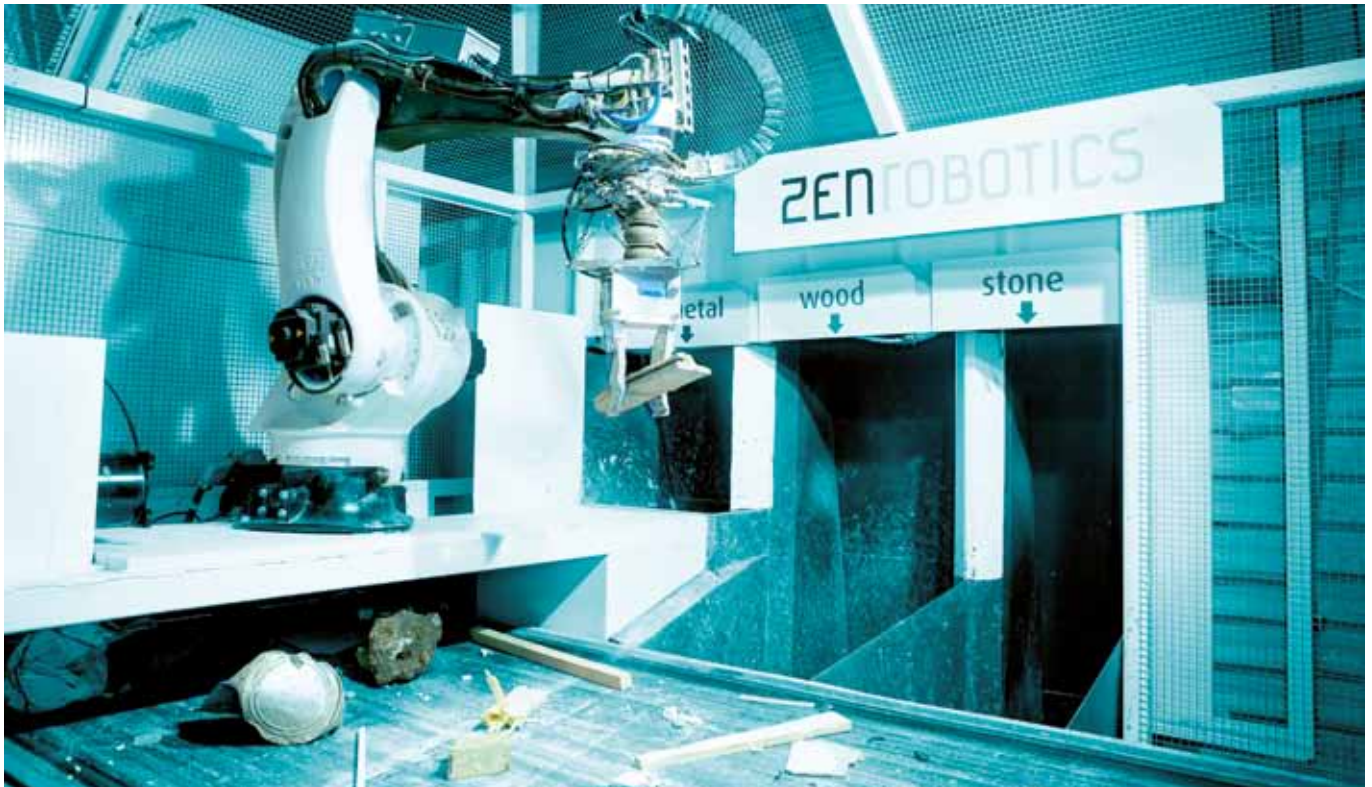
Robotit pystyvät erottamaan rakennusjätteestä puun, metallin ja kiven.
