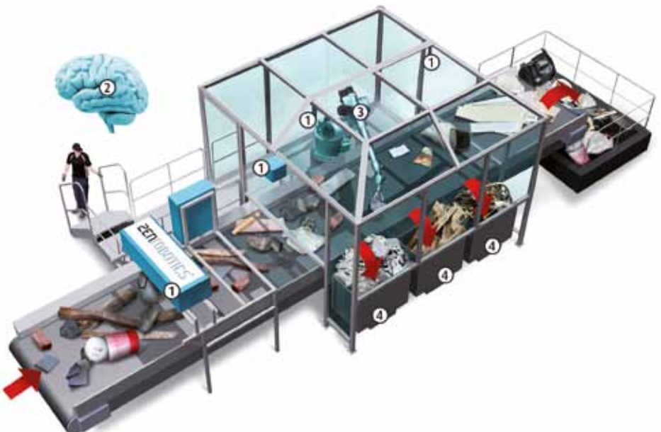
ZenRobotics Recycler -järjestelmä koostuu 1. sensoreista, 2. koko järjestelmää ohjaavasta tekoälystä, 3. roboteista ja 4. kerätystä jättejakeista.
