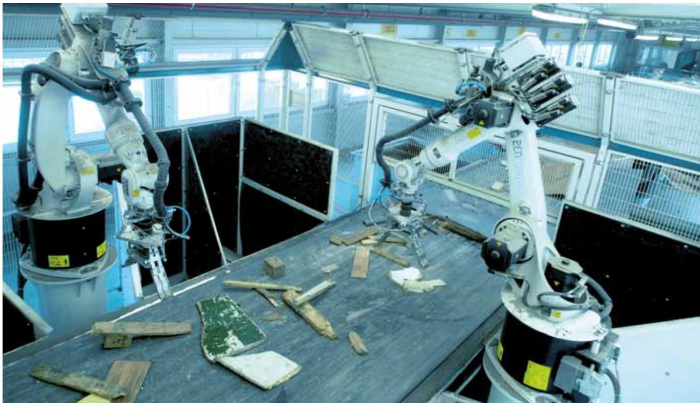
Baetsen Recycling -kierrätyskeskukseen asennettiin viime keväänä kaksi ZenRoboticsin kierrätysrobottia. Hollantilaisyritys uskoo robottien korvaavan viisi työntekijää.
