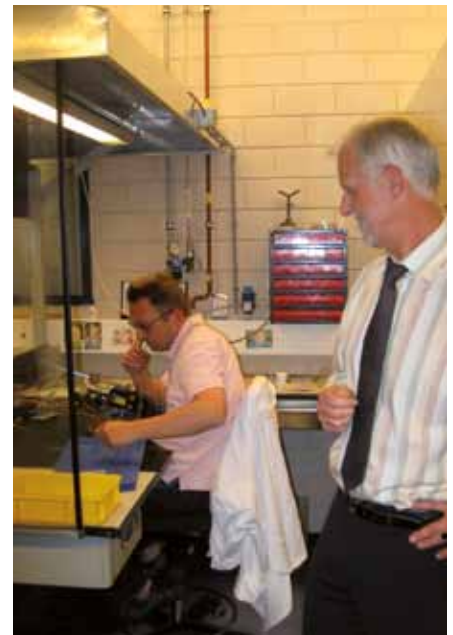
Henk Leijten (oik.) esittelee käsityönä tehtävää pH-anturin lasiputkien viimeistelyä Yokogawan tehtaalla.
