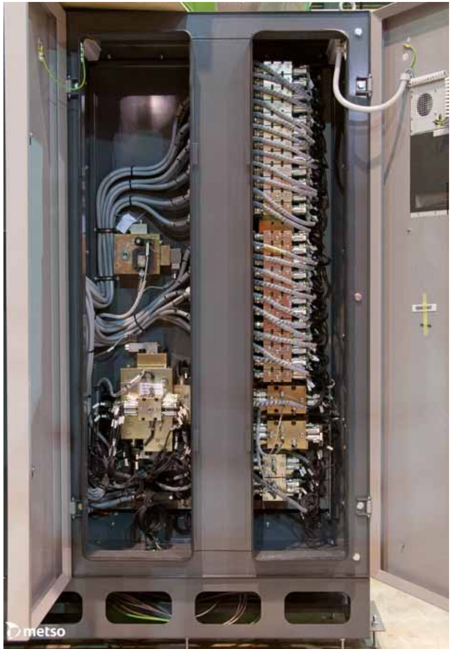
Ensimmäinen Metson monitelakalaneritoimitus digitaalihuoliikalla sisältää 1 500 digitaaliventtiiliä. Kuva: Timo Rätty
