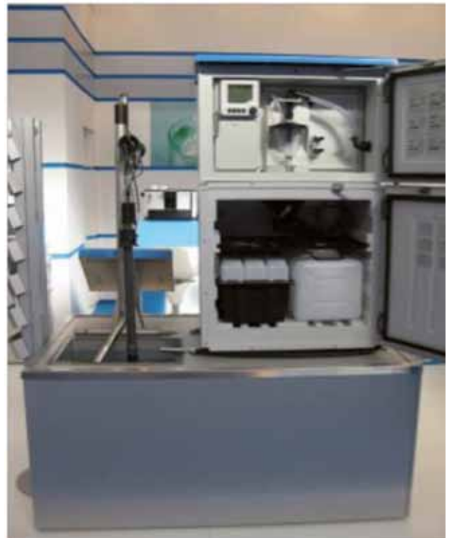
Tältä nähtävät Endress+Hauserin uudet CSF48- ja CSP44 -näytteenottimet lisävarusteiden kanssa. Kuvassa oikealla CSF48 liitettyä CLS50D-anturiin.
