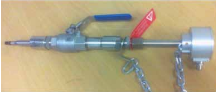
Terminen massavirtausmittari Schmidt SS20.600 voidaan työntää asennusventtiilin läpi.
