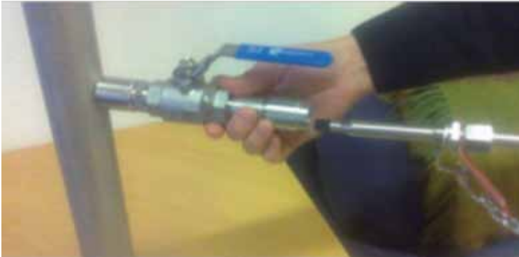
Venttiilasennusratkaisu tekee asennuksen ja irrotuksen mahdolliseksi myös paineenalaiseen putkeen.
