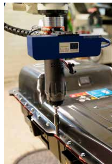
Ruuvien tyyppiä ja paikkaa tunnistaminen kone näön ja tekoälyn avulla. Oikealla liittimien irrottaminen 2-sormisella tarttujalla. (Kuva: Centria, 2024)
